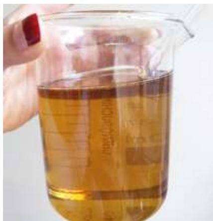
**Oxidación (OXI):** La oxidación es la reacción de las moléculas del lubricante con el oxígeno (Noria Latin America, 2014), **al aumentar el número de oxidación el aceite va aumentando la viscosidad** indicando pérdida de propiedades del aceite. Un aceite con un alto número de oxidación es un aceite viejo que está perdiendo las propiedades que le ayudan a generar la película protectora que evita la fricción en un sistema hidráulico.
