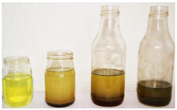
De izquierda a derecha muestra de diésel después de servicio y muestras de tanques contaminados: diésel purificado, diésel contaminado 1, diésel contaminado 2, diésel contaminado 3.
