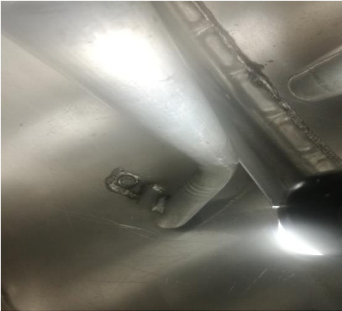
Tanque de aceite hidráulico después de mantenimiento.
