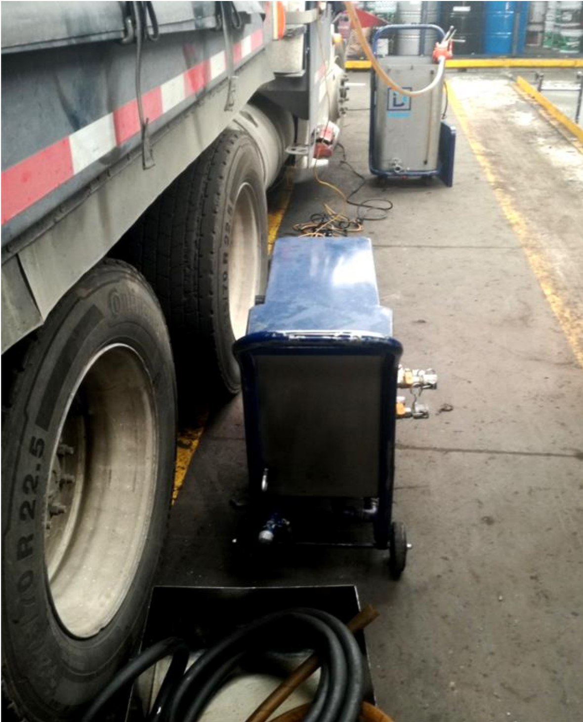
Realización de mantenimiento de aceite hidráulico Disilpem.
